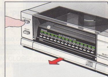
Undgå at åbne skuffen under af-spilning, med mindre du ønsker at stoppe disc'en.
